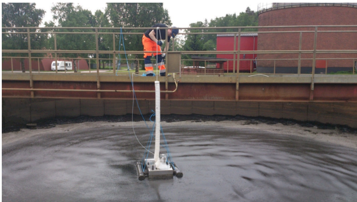
Figur 19. Huvmätning vid öppet rötrestlager.
