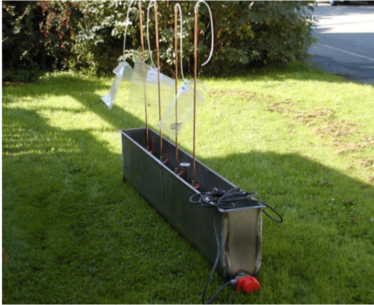
Figur 16. Provtagningsutrustning för mätning av metan i vatten. Bildkälla: BioMil
