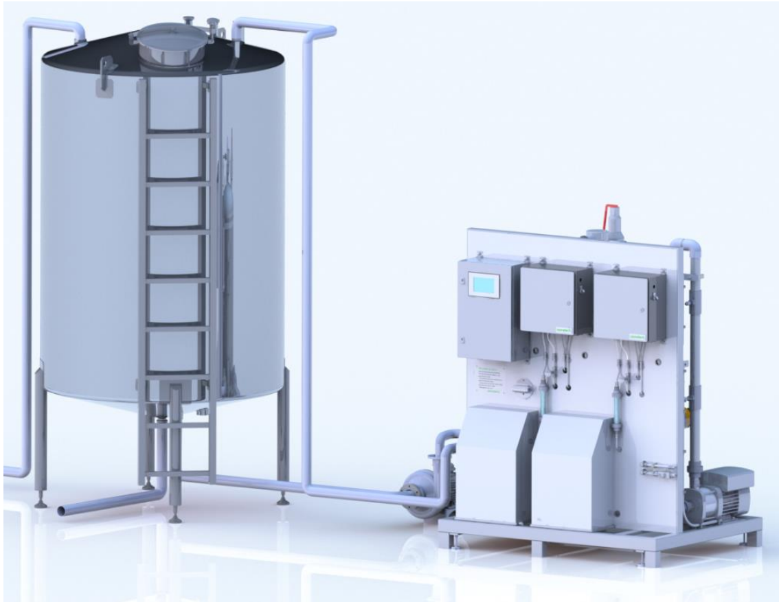
Figur 16, Processkoncept med modulariserade enheter för ozonering av vatten.
