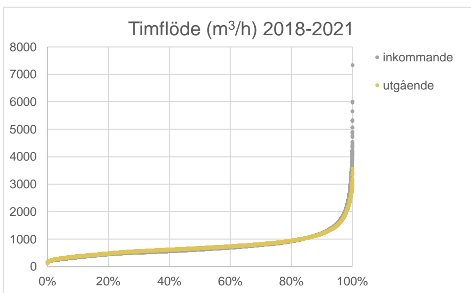
Figur 3. Varaktighetdiagram för inkommande och utgående flöde till Skansverket mellan 2018 och 2021.
