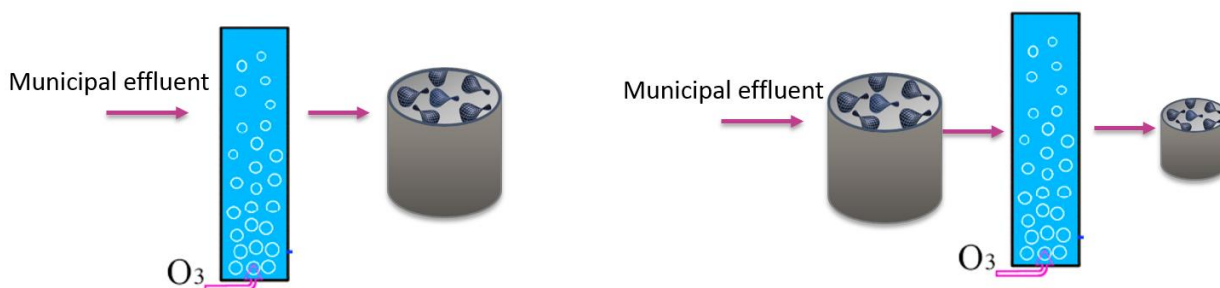
Figur 21: Ozon+MBBR eXenO 3 TM . Till vänster tvåstegsprocess, till höger trestegsprocess.
