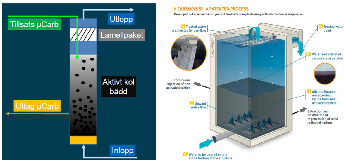
Figur 7. Aktivt kol i fluidiserad bädd från a) Veolia, Opacarb™ och b) Stereau, CarboPlus®.
