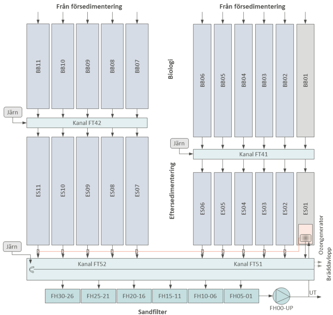
Figur 50. Schematisk processdesign för den alternativa processdesignen för ozonbehandling vid Käppalaverket.
