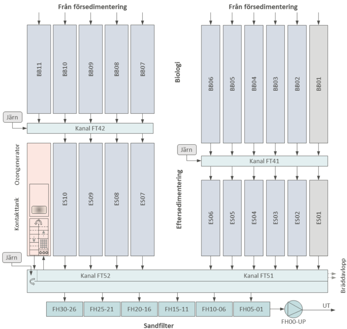
Figur 10 – Schematisk processdesign för den föreslagna ozoneringen vid Käppalaverket.
