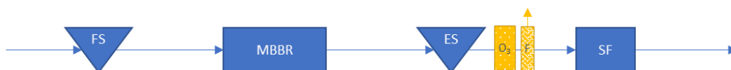
Figur 19. Schematisk illustration och placering av kombination ozonering och skumfraktionering före befintligt SF.
