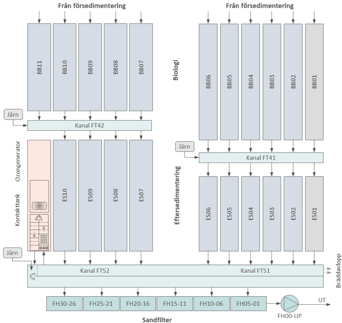
Figur 43. Schematisk processutformning för den föreslagna ozonbehandlingen vid Käppalaverket.
