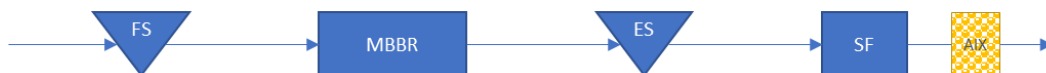
Figur 17. Schematisk illustration och placering av anjonbytare (AIX) som avslutade reningssteg efter befintlig SF.
