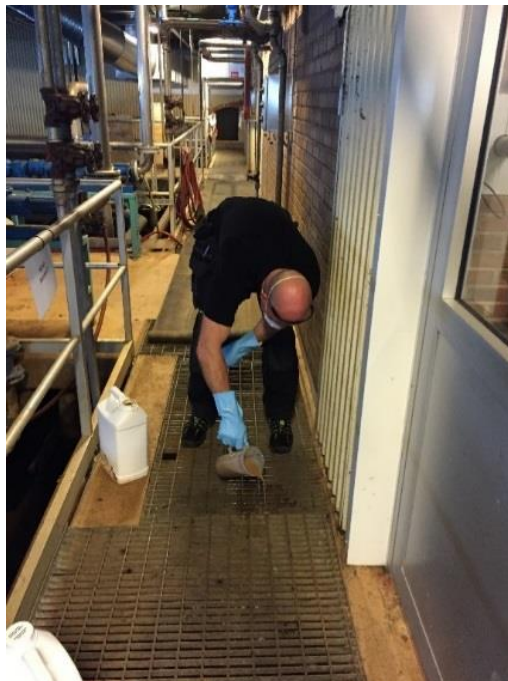
Bild 4 Användning av skyddsutrustning vid dosering Vectobac efter luftningen på Hofors ARV
